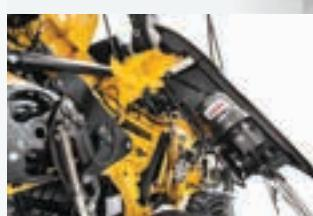
El compartimento para cuerda tiene capacidad máxima para 32 rollos. Los armarios de cuerda ahora son pivotantes, para una limpieza aún más fácil.
