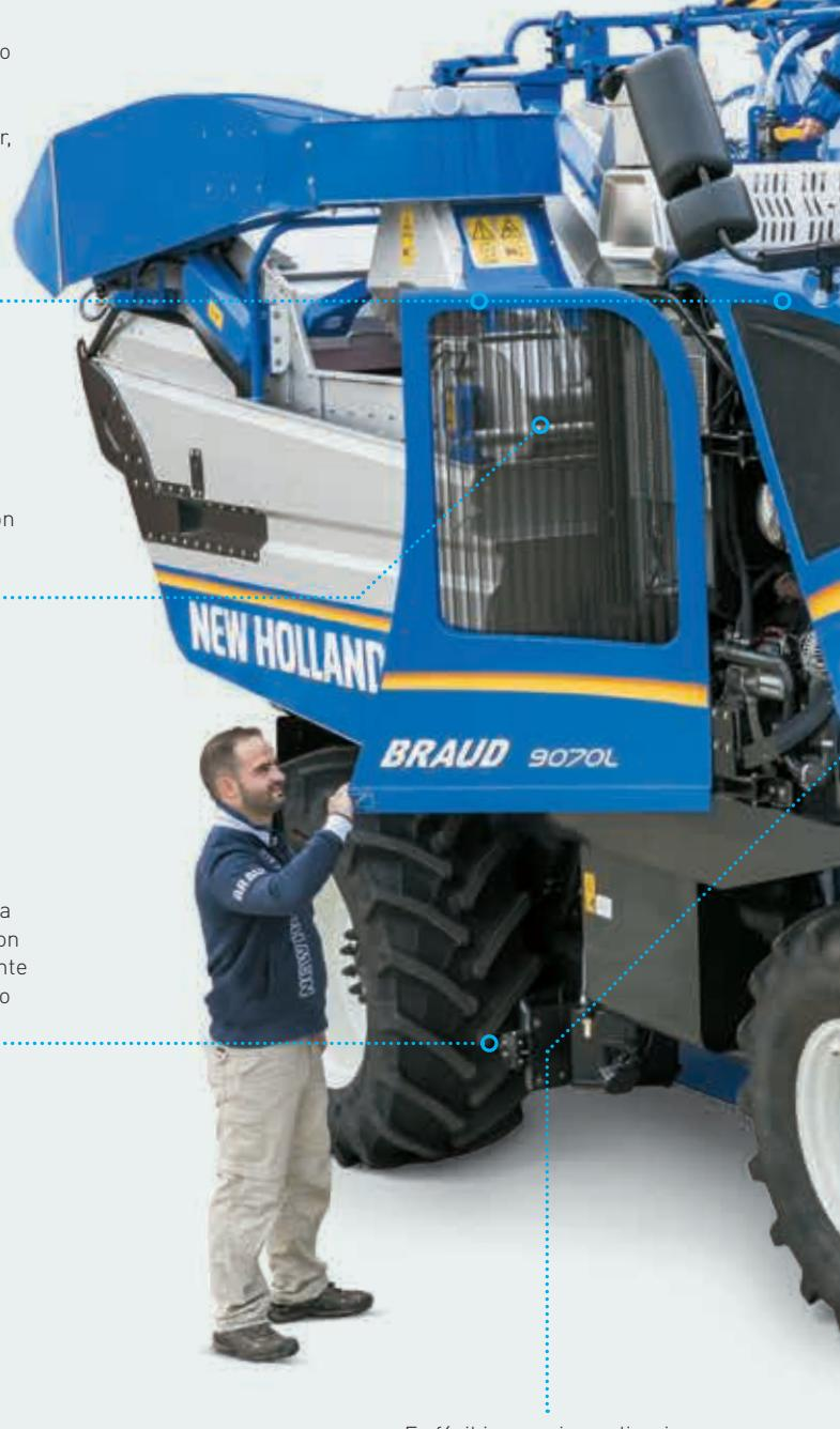
Es fácil inspeccionar, limpiar o sustituir el filtro de aire del motor sin necesidad de herramientas y desde el suelo.
