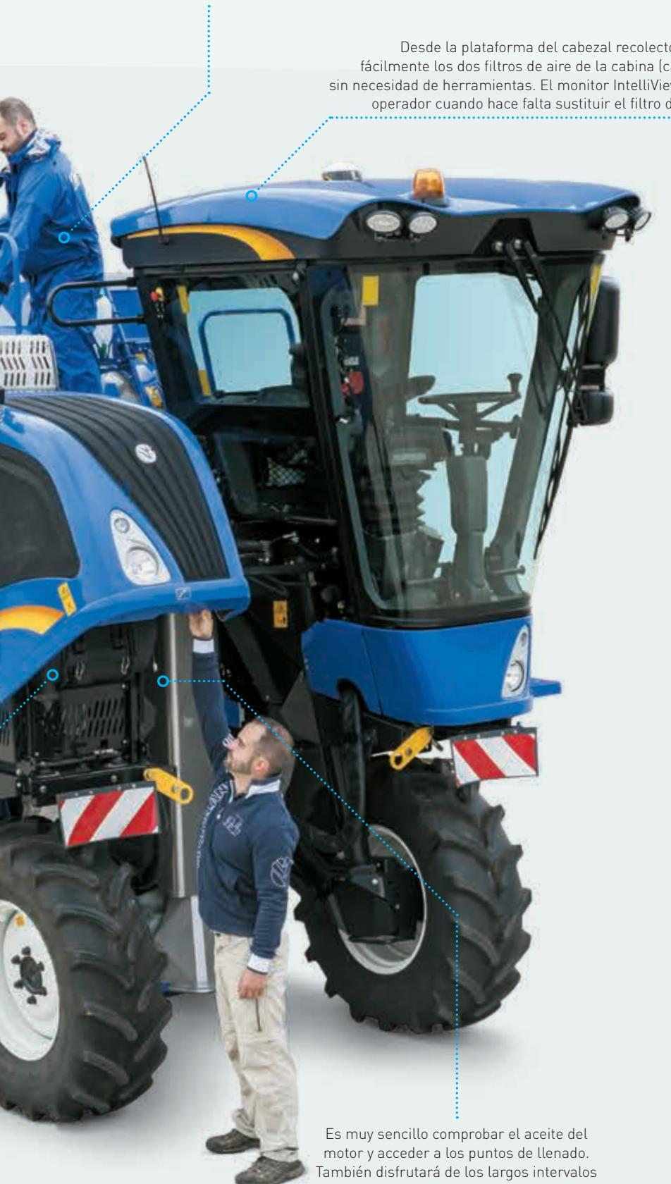
Desde la plataforma del cabezal recolector se cambian fácilmente los dos filtros de aire de la cabina (categoría 2 y 4) sin necesidad de herramientas. El monitor IntelliView™ IV avisa al operador cuando hace falta sustituir el filtro de categoría 4.
