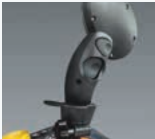
Umschalttaste und Entsperrung des Fahrhebels (hinten).
