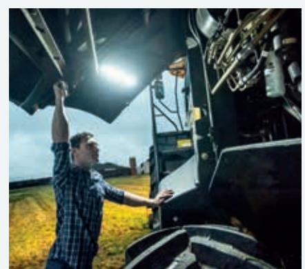
El conjunto de luces LED en las compuertas laterales facilita aún más las tareas de mantenimiento cuando ya no hay luz solar disponible.
