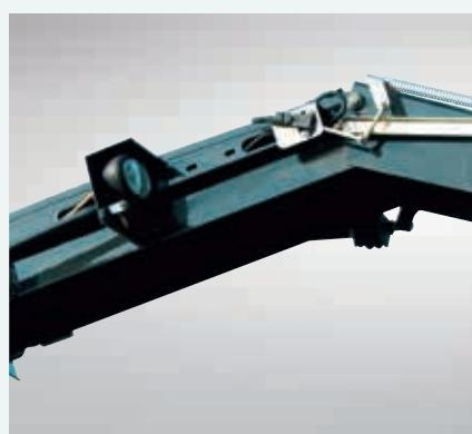
Se han instalado seis faros de trabajo en zonas esenciales, como el tubo de descarga, la plataforma para mantenimiento y el parachoques, con el fin de mejorar la precisión de la cosecha en condiciones de luz insuficiente.
