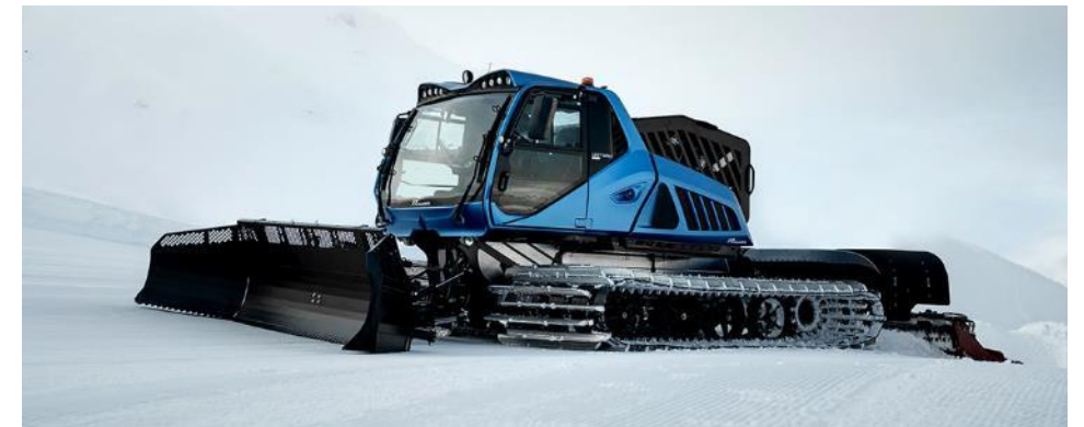
Dameuse Prinoth avec moteur Cursor XC13 460ch
