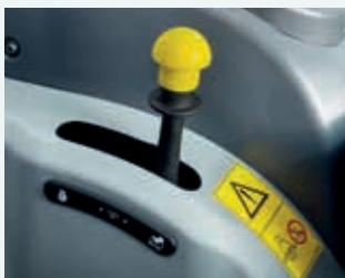
Die Traktoren können mit einer Wegzapfwelle ausgestattet werden. Die Sanftanlauffunktion der Zapfwelle schützt Ihre Geräte und Ihren Traktor. Die automatische Zapfwellenschaltung schaltet die Zapfwelle beim Wenden auf dem Vorgewende aus und wieder ein.
