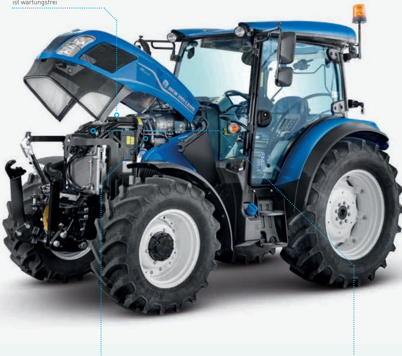
Alle Wartungsarbeiten können von einer Traktorearseite aus ausgeführt werden. Die Wartungspunkte sind zugangsfreundlich auf der linken Seite angeordnet
